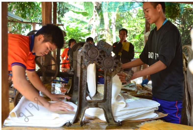
ภาพประกอบ 16 นักเรียนฝึกทักษะปฏิบัติการทำยางแผ่นดิบโดยใช้มือและเครื่องรีด
