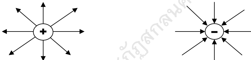
รูป 1 แสดงเส้นแรงไฟฟ้า จากจุดประจุบวกอิสระ และจุดประจุลบอิสระ
