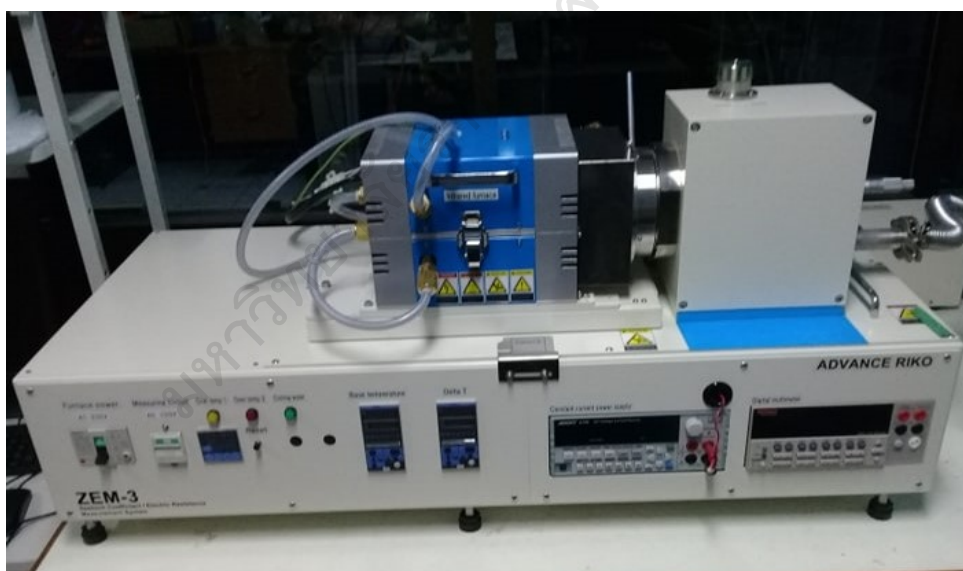
ภาพประกอบ 23 ค่าสภาพนำไฟฟ้า/ค่าสภาพต้านทานไฟฟ้า วัดด้วยเครื่อง ZEM-3 series
