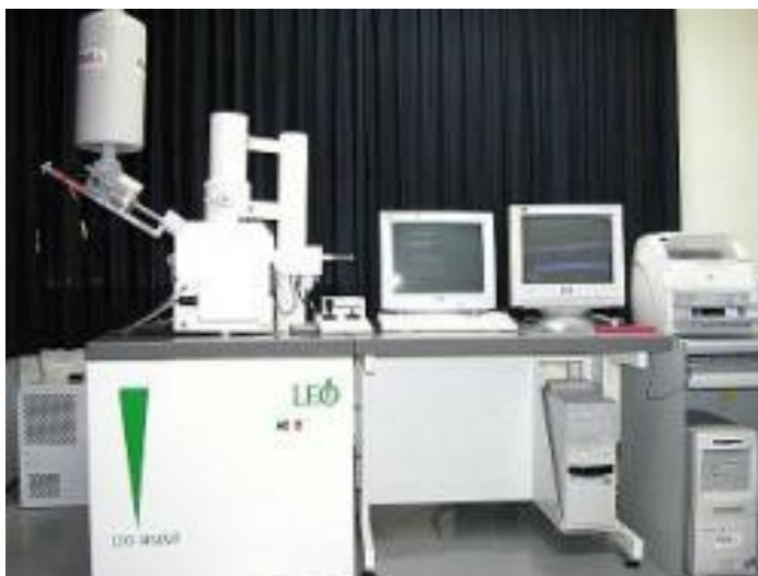
ภาพประกอบ 20 กล้องจุลทรรศน์อิเล็กตรอนแบบส่องกราด (Scanning Electron Microscope (SEM) ยี่ห้อ LEO รุ่น 1450VP)
