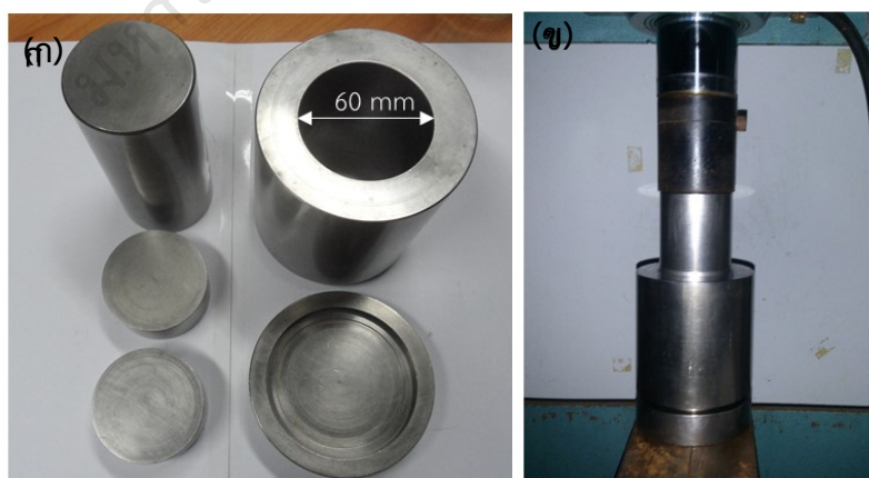
ภาพประกอบ 15 การเตรียมเป่าสปีดเตอร์ริง (ก) ส่วนประกอบโมลัด (ข) การขึ้นรูปเป่าสปีดเตอร์ริง
