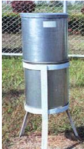
ภาพประกอบ 118 เครื่องวัดปริมาณน้ำฝนแบบแก้วตวง (กรมอุตุนิยมวิทยา, 2019)
