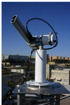
ภาพประกอบ 112 เครื่องซันโฟโตมิเตอร์ (sun photometer)
