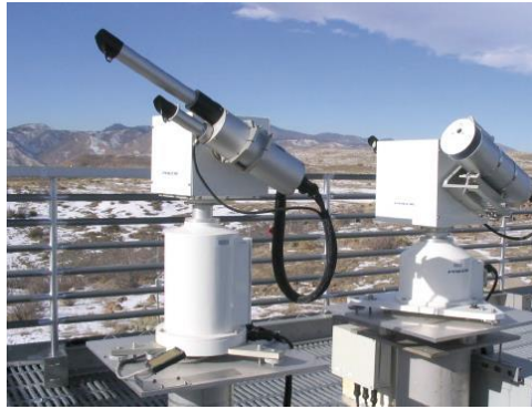
ภาพประกอบ 114 เครื่องสกายเรดิโอมิเตอร์ (sky radiometer)
