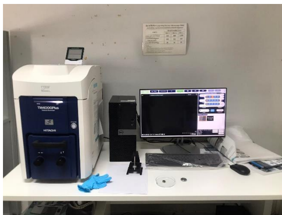
ภาพประกอบ 30 กล้องจุลทรรศน์อิเล็กตรอนแบบส่องกราด
