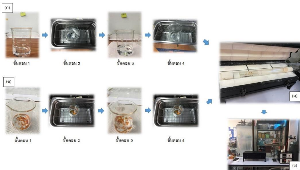
ภาพประกอบ 23 ขั้นตอนในการทำความสะอาดแผ่น \text{SiO}_2 และ PI
