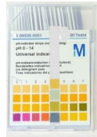
นำกระดาษลิตมัสที่จุ่มลงไป ในเจลแอลกอฮอล์ มาเทียบสี พร้อมอ่านค่า pH
