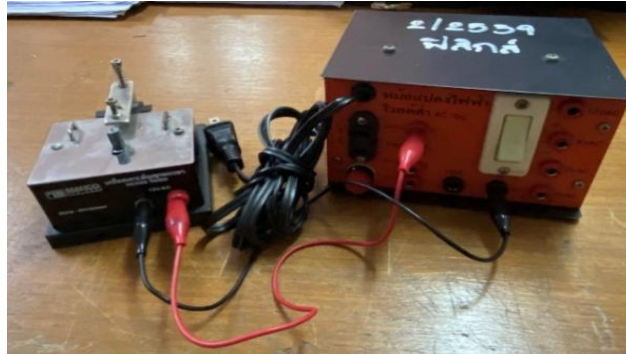
ภาพที่ 2.2 แสดงการต่อเครื่องเคาะสัญญาณเวลากับหม้อแปลงโวลต์ต่ำ
