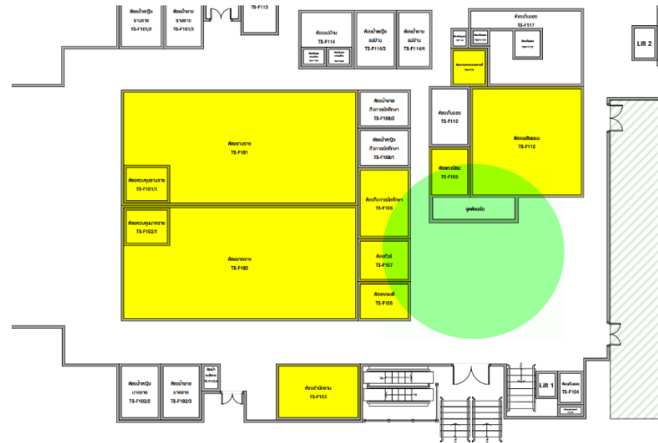
ภาพประกอบ 8 พื้นที่ห้องทำงานและสัญญาณอินเทอร์เน็ต บริเวณชั้น 1 อาคารศรีโคตรบูรณ
