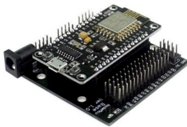
ภาพประกอบ 9 เมนบอร์ดชุดควบคุม NodeMCU ESP8266
