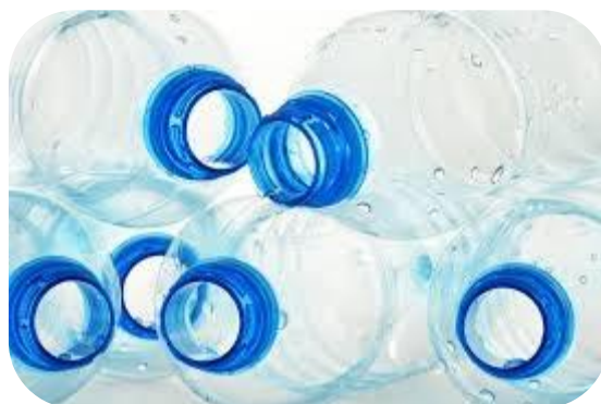
ภาพประกอบ 8 ขวดน้ำ (พอลิเอทิลีนเทเรฟทาเลต) จัดเป็นเทอร์มอพลาสติก
